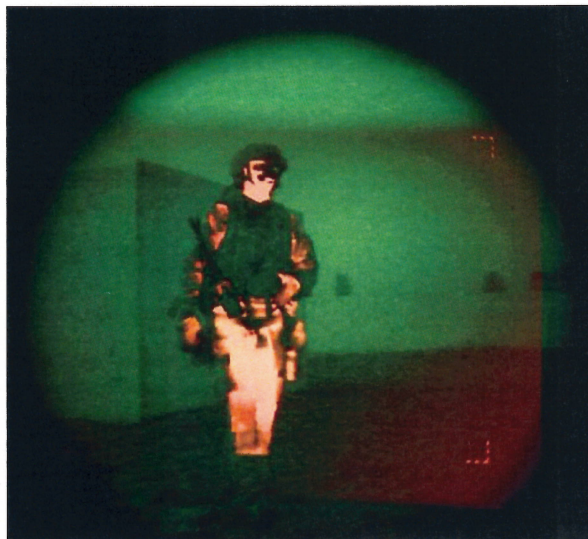
■ Night Enforcer Fusion v sobě slučuje noktovizor s termovizí, a umožňuje dvojí zobrazení – jak samostatně, tak i v kombinaci.
