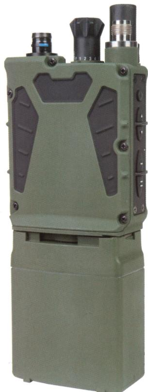
RF-7850S je nejnovější a nejvýkonnější personální radiostanice na světě a úspěšně navazuje na typ RF-7800S-TR. Při vývoji radiostanice RF-7850S byly využity jak mnoholeté zkušenosti z vývoje a výroby, tak i zpětné vazby od velkého počtu uživatelů radiostanic PRC-117F/G, PRC-152/152A a RF-7800S. Parametry radiostanic RF-7850S jsou: pásmo 225MHz – 2GHz, provozy NB,WB, MANET, Duplex, FM, IP, RS232, GPS, datová rychlosť až 1Mb/s.
