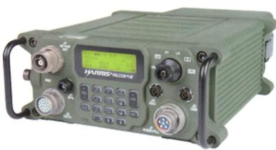
automatického dynamického nastavení šířky kanálu a tím zajišťuje maximální využití frekvenčního pásma. Radiostanice RF-7800H-MP úspěšně navazuje na KV radiostanici PRC-150 zavedenou u většiny NATO armád s provozem Mil-STD, ALE 2G, 3G a 3G+.
